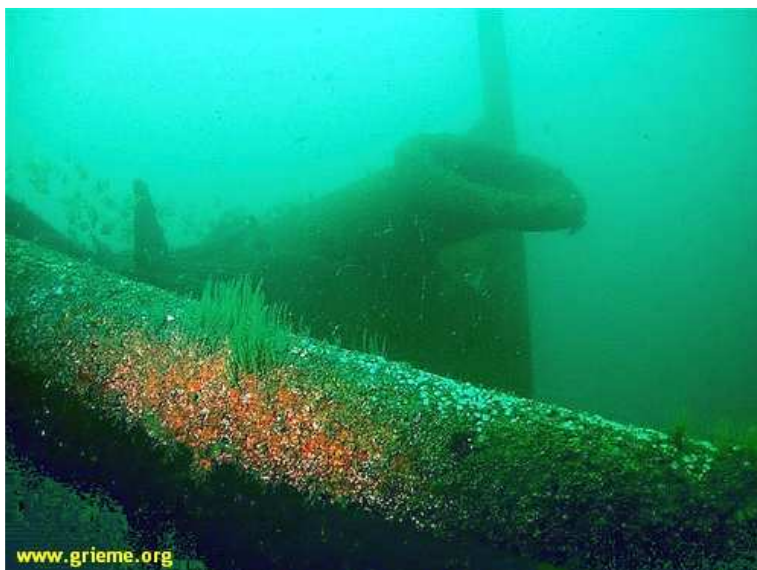
En premier plan le porte paravane, en second plan l'écubier et au fond, l'arrête de proue (Photo GRIEME).
