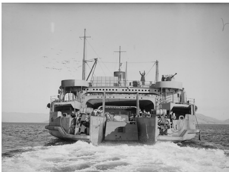
L'arrière du HMS Daffodil. On distingue nettement la rampe, les racks pour les mines anti sous-marines, la cheminée centrale et les deux plateformes pour les canons, dont un seul est en place (Document Imperial War Museum).
